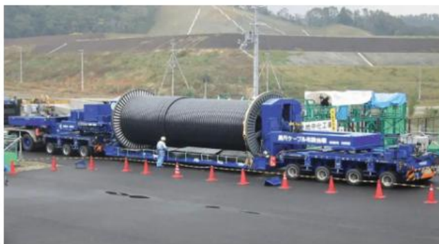
图 1 大长度高压/超高压电缆运输
