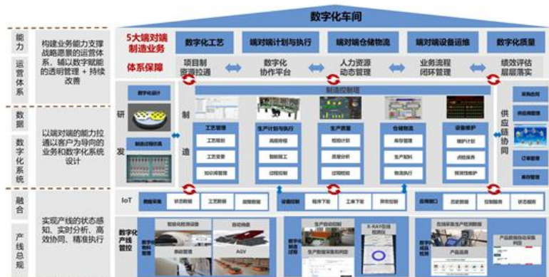
图 12 电力电缆数字化车间蓝图
