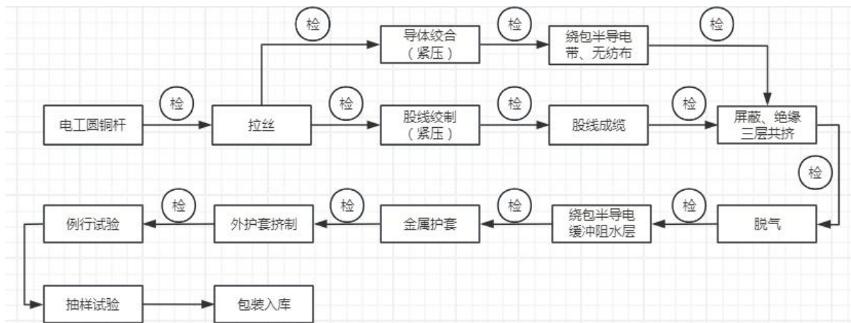
图 6 110kV 环保高压电力电缆工艺流程
